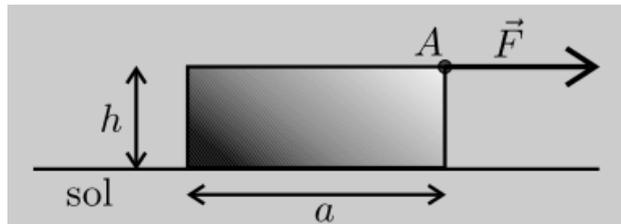
Figure 1: Schéma du meuble que l'on souhaite tirer.
