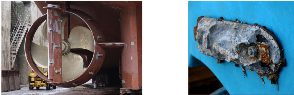
FIGURE 15.10 – A gauche : anodes sacrificielles sur l'hélice d'un bateau. A droite : anode sacrificielle en fin de vie. Source : poly de cours de Etienne Thibierge.
