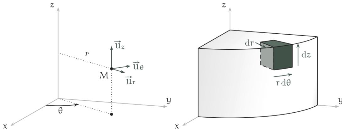
★ On définit un repère orthonormé **mobile**  $(M, \vec{u}_r, \vec{u}_\theta, \vec{u}_z)$  et la position de tout point  $M$  de l'espace est donnée par les coordonnées  $r$ ,  $\theta$  et  $z$ . On a  $\overrightarrow{OM} = r\vec{u}_r + z\vec{u}_z$ .
