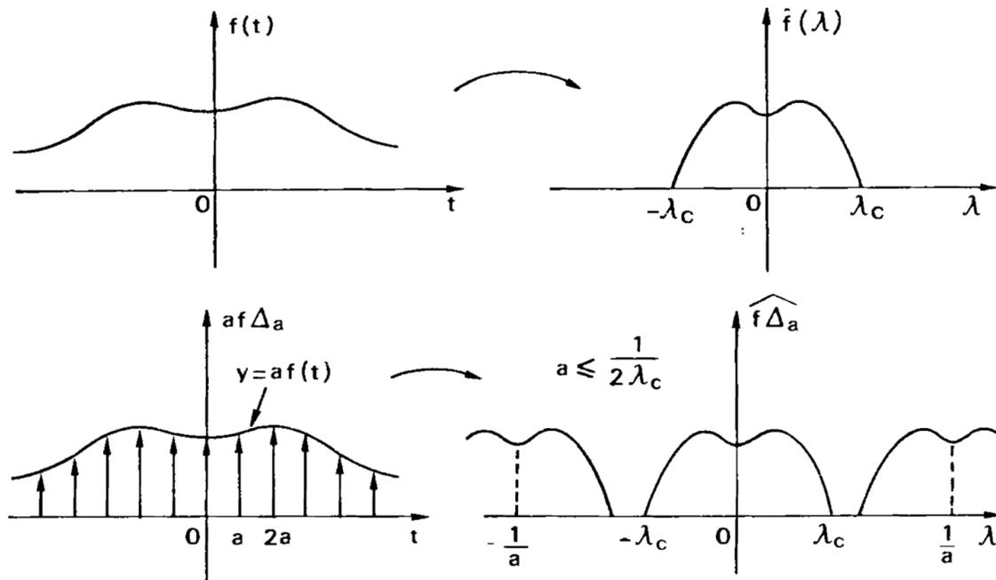
Sur les figures,  $a$  représente la période d'échantillonnage et  $\lambda_c$  est la fréquence maximale du spectre du signal. On voit donc que le fait d'échantillonner un signal revient à périodiser son spectre.
