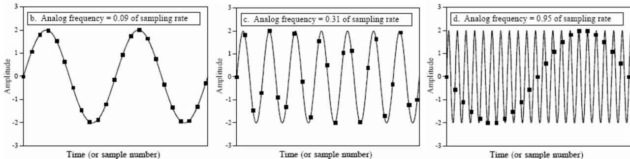
Les deux premiers signaux sont correctement échantillonnés bien que ce ne soit pas évident sur le deuxième signal. On se rend bien compte du phénomène de sous-échantillonnage avec le troisième exemple : le signal initial n'est pas du tout reconstitué et il est évident qu'une analyse de Fourier basée sur ces échantillons donnera des résultats faux. Pour pouvoir s'affranchir de ce problème, il faut que
