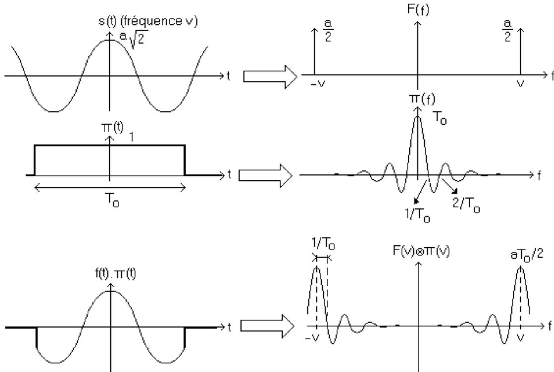
Pour le calcul d'une transformée de Fourier à l'oscilloscope, la fenêtre choisie n'est pas forcément rectangulaire. Dans le cas général, on multiplie le signal par une fenêtre dite de pondération (ou d'apodisation). Il existe beaucoup de formes de fenêtres dont on choisira le profil afin d'obtenir une transformée de Fourier avec une forme optimale en fonction de ce que l'on veut faire. On trouve des fenêtres qui donnent des pics :
