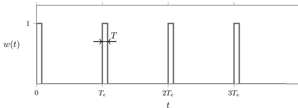
**Q.2** Représenter le signal  $x_e(t)$  pour  $f_e = 4f_0$ ,  $f_e = 2f_0$  et  $f_e = \frac{4}{3}f_0$ . Montrer qualitativement que, dans l'un des cas, le signal échantillonné n'est pas représentatif du signal analogique de départ.
