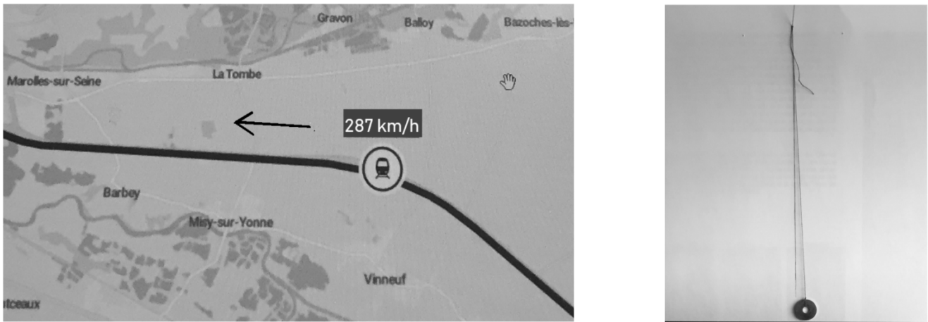
FIGURE 3 – La carte permet d'estimer que le rayon de courbure du virage lors de la réalisation de l'expérience est R_C = 4 km. Sur la photo à droite, le segment noir matérialise la verticale lorsque le train est à l'horizontale et immobile.
