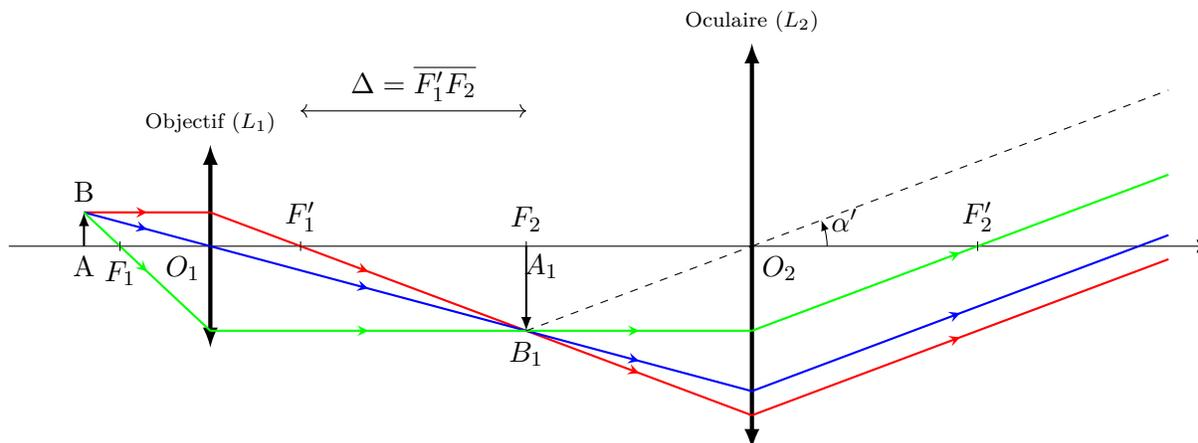
La mise au point s'effectue pour :  $\overline{F_1 A} = -\frac{f_1'^2}{\Delta}$ .
