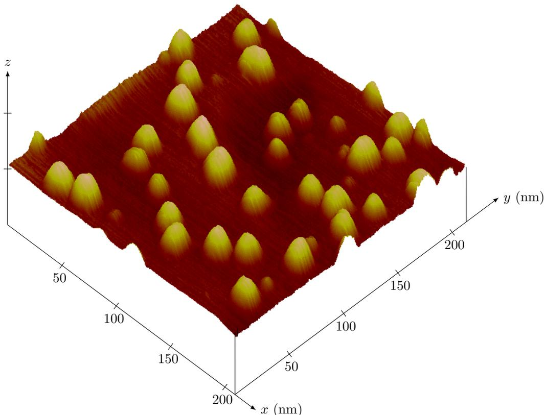
**Figure 4** Ensemble de boîtes quantiques de GaN (matériau  $A$ ) déposées à  $705\text{ }^{\circ}\text{C}$  sur un substrat d'AlN (matériau  $B$ ) et mûries sous vide. Image obtenue par microscopie à force atomique. Source : CEA-Grenoble/DSM/DRFMC/SP2M Rapport d'activité 1996-1998 du SP2M
