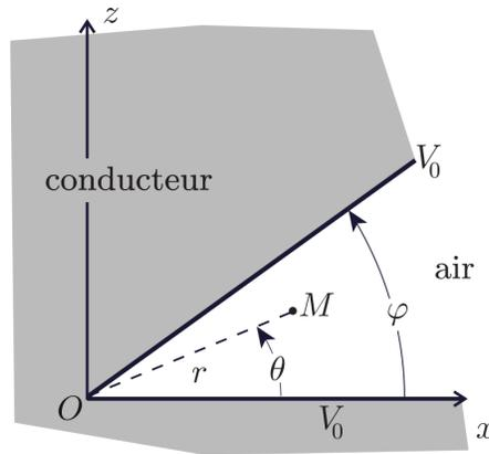
FIGURE 2 – Modèle de coin.
