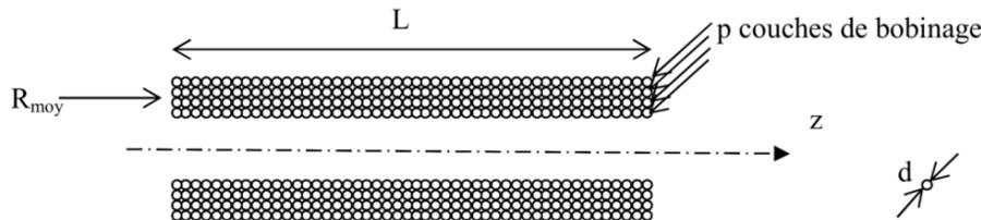
FIGURE 1 – Bobine comportant plusieurs couches de bobinage
