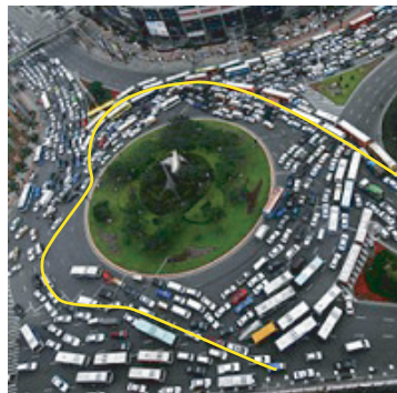
Ligne de courant : tangente en chacun de ses points aux véhicules et déterminée à un seul instant donné.
