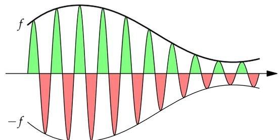
Plus la fréquence du signal modulé en amplitude est élevée, plus chaque arche compense exactement l'arche précédente, de telle sorte que l'aire totale se rapproche de 0.
