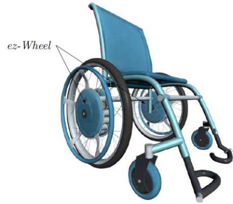
Figure 2 : Prototype de fauteuil roulant équipé de deux ez-Wheel
