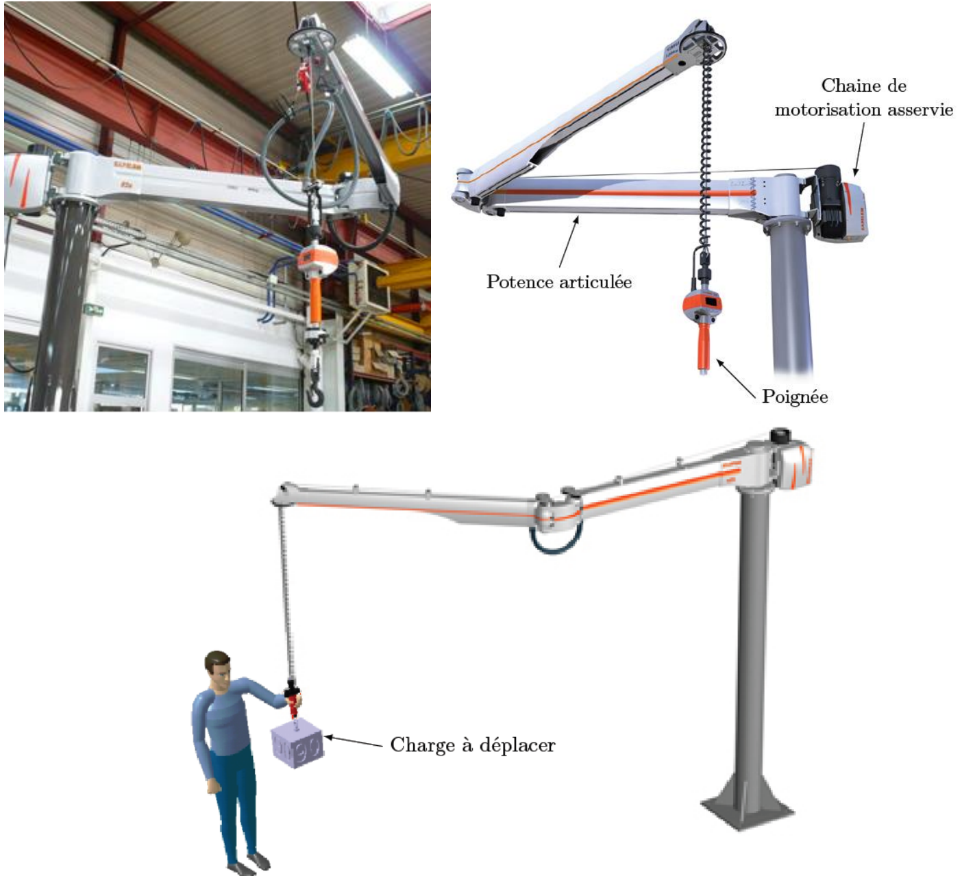
Figure 11 : Photos du bras manipulateur collaboratif sapelem et d'un environnement de manutention
