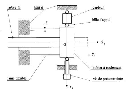
L'arbre 1 (avec la poulie), de masse  $m_I$ , a pour moment d'inertie  $I_I$  par rapport à l'axe  $(O, \vec{x}_0)$  et est équilibré en rotation.
