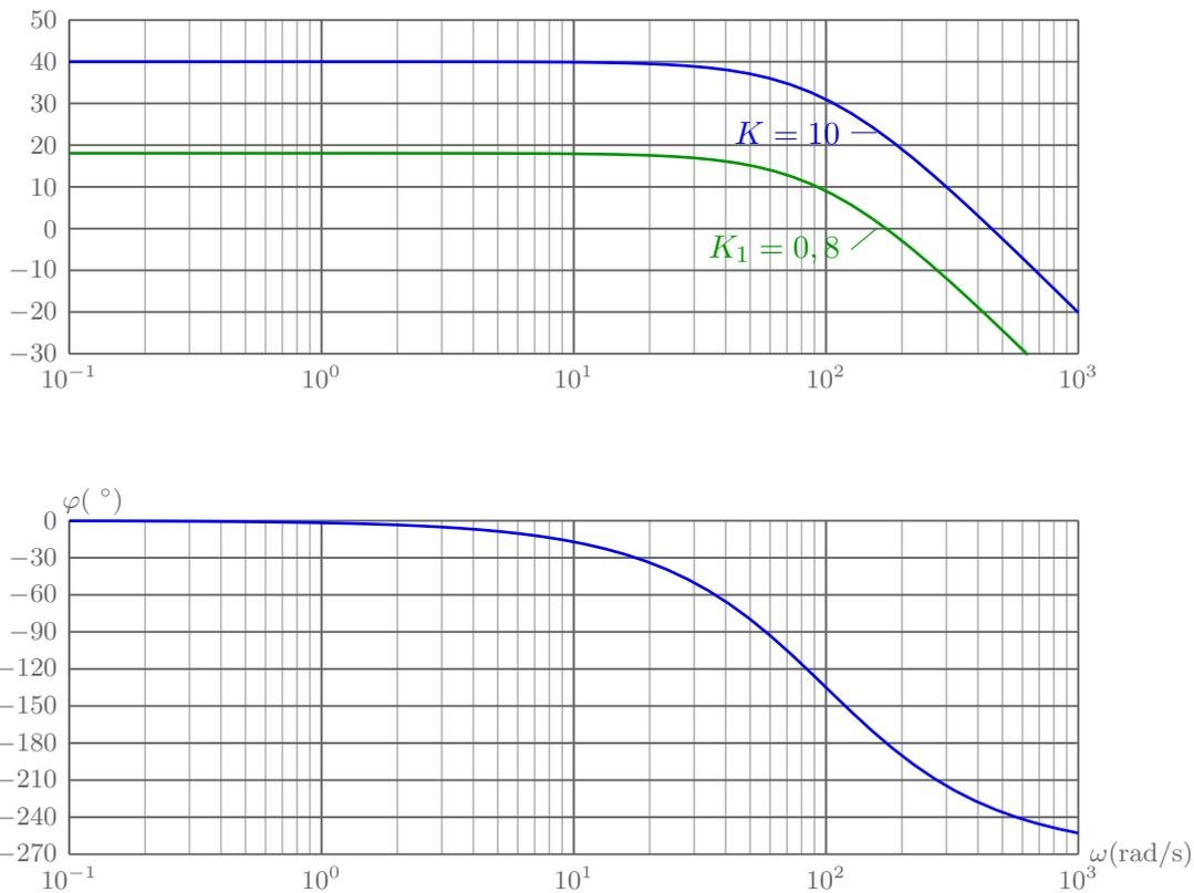
Les marges de stabilité sont nulles puisque l'on est à la limite de la stabilité. (Voir tracé précédent).
