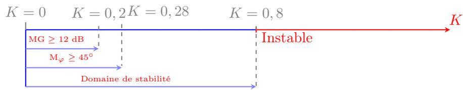
Vis-à-vis des marges de stabilité couramment utilisées ( $M_G = 12 \text{ dB}$  et  $M_\varphi = 45^\circ$ ), c'est le réglage de la marge de gain qui est la plus contraignante.
