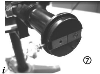
Éclairer la fente ⑦ du collimateur au moyen d'une source lumineuse (lampe spectrale à vapeur de sodium). Régler sa largeur à environ 0,5 mm.
