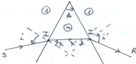
On considère un prisme d'angle  $A$  et d'indice  $n$  plongé dans l'air d'indice 1. Les angles sont orientés comme sur la figure. On appelle déviation du prisme l'angle  $D$  que font les prolongements des rayons incidents  $SI$  et émergent  $I'R$ .
