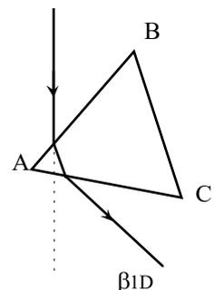
Faire tourner très lentement la platine porte-prisme, tout en suivant à la lunette le déplacement de l'image de la fente à travers le prisme : l'image se déplace dans un sens, puis rétrograde, bien que le prisme continue à tourner dans le même sens : la déviation pour laquelle on observe l'inversion de sens est la déviation minimale.
