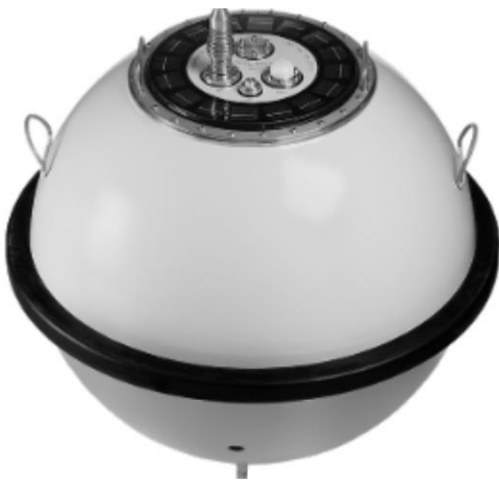
Figure 1 Photographies d'une bouée houlographe Waverider
