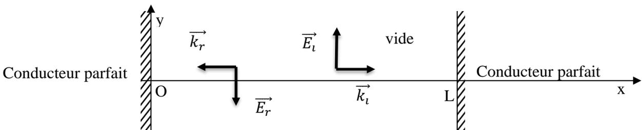
Supposons qu'il s'installe une OEM stationnaire dans une cavité par réflexion sous incidence normale sur deux plans placés en  $x = 0$  et  $x = L$ . On suppose cette onde polarisée rectilignement suivant (Oy).
