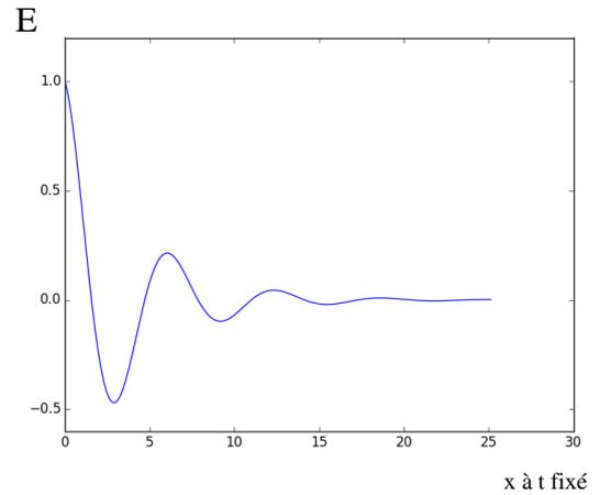
**Effet de peau** en régime rapidement variable : une OEM ne pénètre dans un métal que sur une petite épaisseur de l'ordre de  $\delta$  appelée **distance caractéristique d'atténuation** de l'onde dans le métal.
