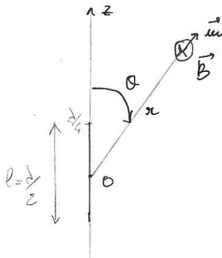
① Relation de structure d'une onde plane  $\underline{\vec{B}} = \underline{\vec{u}}_r \wedge \underline{\vec{E}}$
