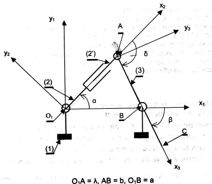
**Question 1** Écrire l'équation de fermeture des torseurs cinématiques de la chaîne de solides [(1),(2),(2'),(3),(1)]. En déduire les deux équations vectorielles qui lient l'une les vitesses de rotation, l'autre les vitesses du point A.
