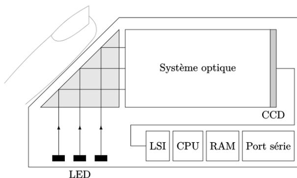
**Figure 2** Principe d'un capteur optique d'empreinte digitale
