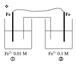
🔖 On observe la corrosion du fer dans la zone la plus diluée.
