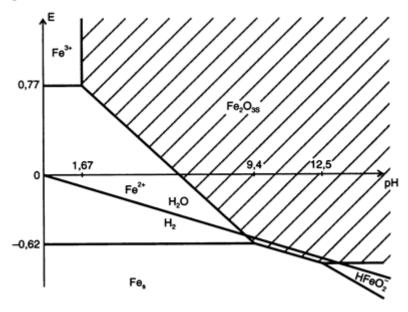
Placer les trois domaines : corrosion, immunité, passivation.
