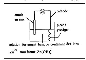
Electrolyse à anode soluble
