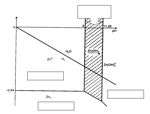
Placer les domaines de corrosion, d'immunité et de passivation.
