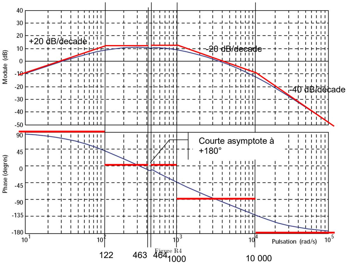
**Q 17.** En adoptant  $K = 1$ , tracer directement sur la figure R4 du document réponse, le diagramme de Bode (module et phase) de  $C(p)$  : diagrammes asymptotiques et allures des tracés réels avec les valeurs prises aux points caractéristiques.
