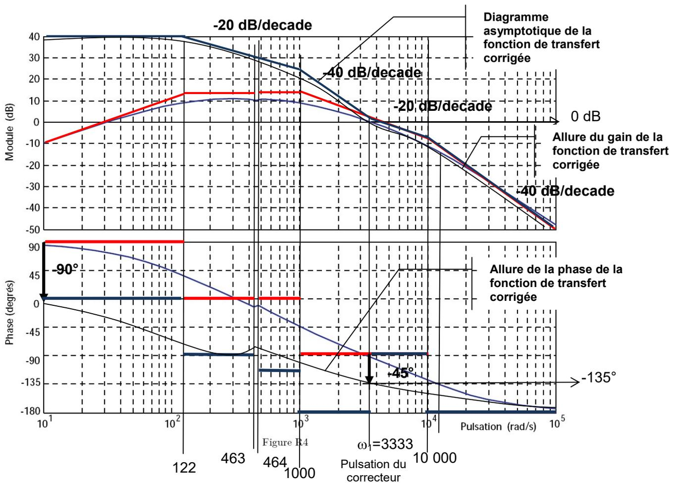
Complément : tracé des diagrammes de Bode de la fonction de transfert corrigée en boucle ouverte
