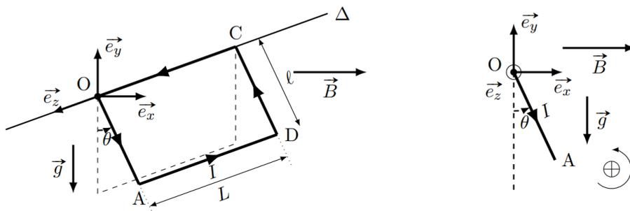
On note  $m$  la masse du cadre et  $J_z$  son moment d'inertie par rapport à l'axe  $\Delta$ . Une alimentation, non représentée sur la figure, impose un courant stationnaire, d'intensité  $I$  le long du cadre, dans le sens indiqué sur la figure ( $I > 0$ ). Enfin, le cadre est immergé dans un champ magnétique uniforme et stationnaire  $\vec{B} = B\vec{e}_x$  où  $B > 0$ . On néglige l'auto-induction dans le cadre.
