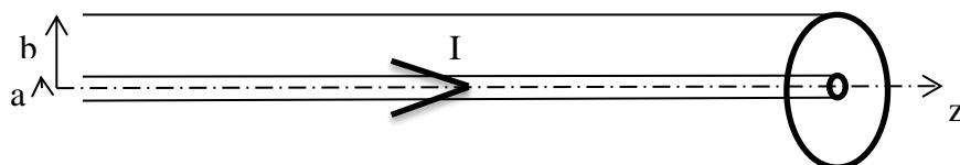
Un câble est constitué de deux conducteurs cylindriques métalliques de même axe ( $Oz$ ). Ils sont de longueur très grande devant leurs rayons  $a$  et  $b$  (avec  $a < b$ ). Le conducteur intérieur est appelé l'âme. Le conducteur extérieur, appelé la gaine, a une épaisseur négligeable. Ils sont séparés par un isolant diélectrique que l'on assimilera au vide.
