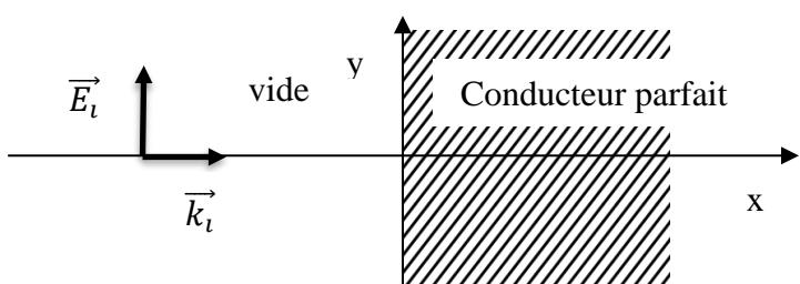
Une OEMPPM incidente se propage dans le vide et arrive sous incidence normale à la surface d'un conducteur parfait.
