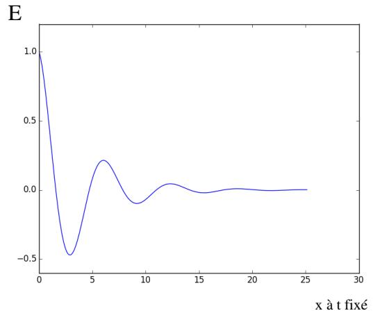
**Effet de peau** en régime rapidement variable : une OEM ne pénètre dans un métal que sur une petite épaisseur de l'ordre de  $\delta$  appelée **distance caractéristique d'atténuation** de l'onde dans le métal.
