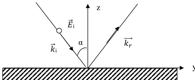
Une onde plane progressive monochromatique dans le vide se réfléchit sur un métal parfaitement conducteur avec
