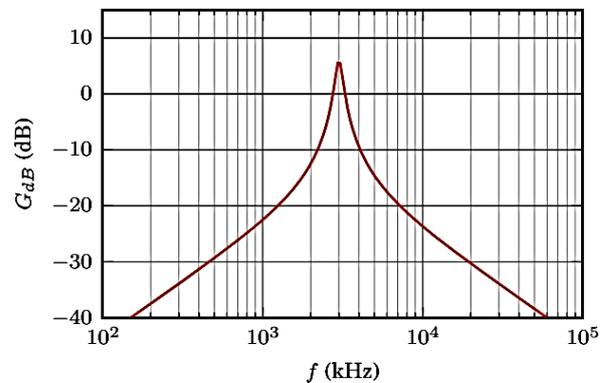
Figure 5 – Diagramme de Bode du filtre.
