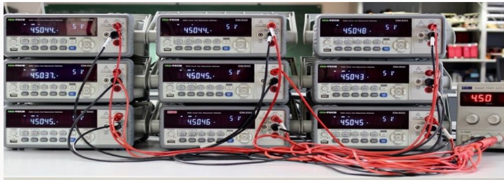
Plusieurs voltmètres de la même référence branchés en parallèle sur une source de tension.
