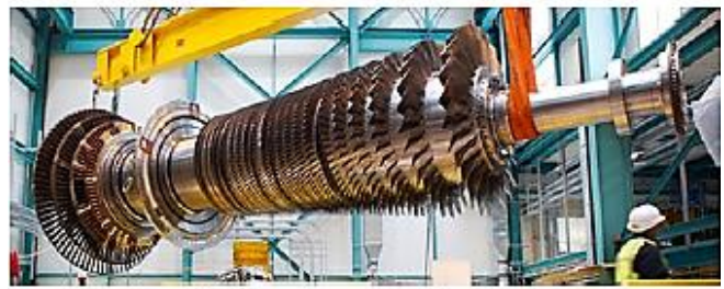
Turbine d'une centrale à gaz.
