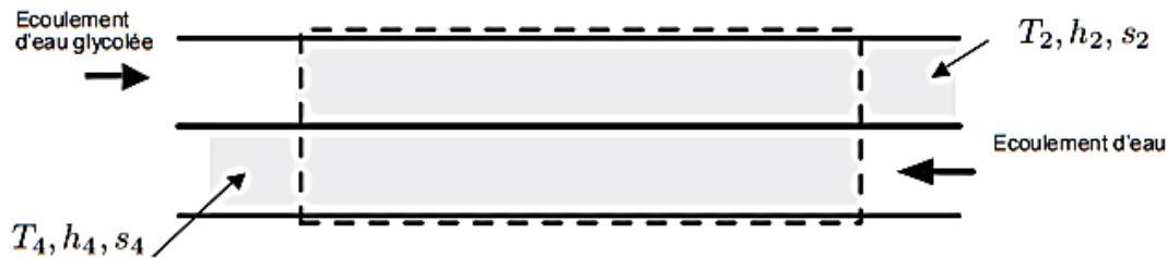
FIGURE 8 – Echangeur à l'instant final.
