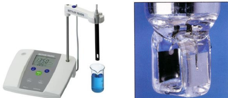
Photographie d'un conductimètre et zoom sur la cellule conductimétrique
