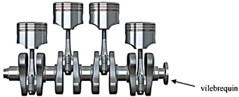
Figure 4 - Quatre pistons montés sur vilebrequin
