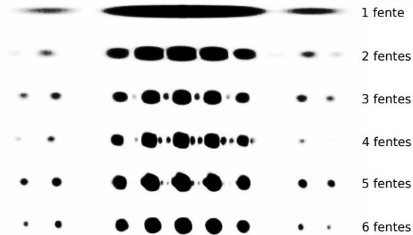
Fig. 2 : Figures obtenues par passage d'un laser au travers de 1 à 6 fentes. Plus le nombre de fentes éclairées est élevé, plus les taches brillantes sont lumineuses.
