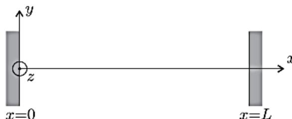
FIGURE 1 – Cavité optique.
