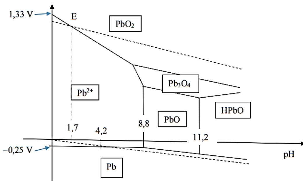
**Figure 5 - Diagramme potentiel-pH du plomb**
