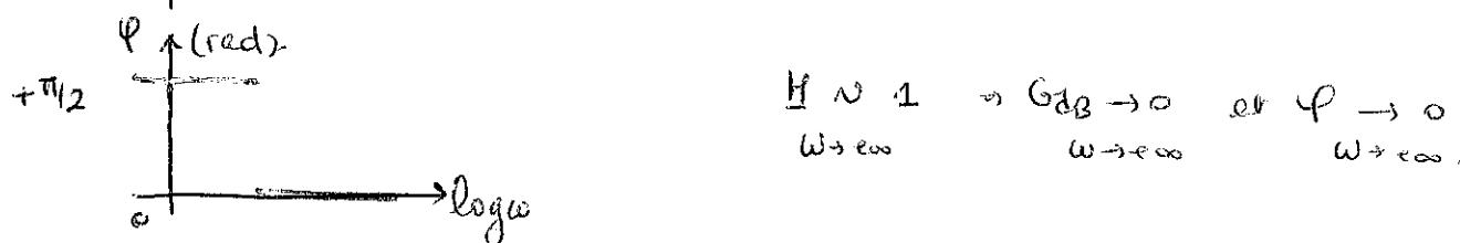
17). ici  $G(\omega_c) = \frac{RC\omega_c}{\sqrt{1 + (RC\omega_c)^2}}$  et  $G_{max} = 1 \Rightarrow \omega_c = \frac{1}{RC}$ .
