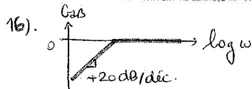
car  $H \sim jRC\omega \Rightarrow G_{dB} \sim 20 \log(RC\omega)$  et  $\varphi \rightarrow +\frac{\pi}{2} \text{ rad}$
