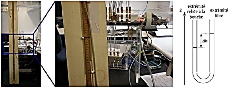
Figure 8 Colonne d'eau en U utilisée pour calibrer le capteur de pression.
