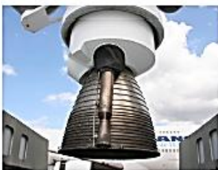
Tuyère d'éjection du moteur Vulcain qui équipe la fusée Ariane.
