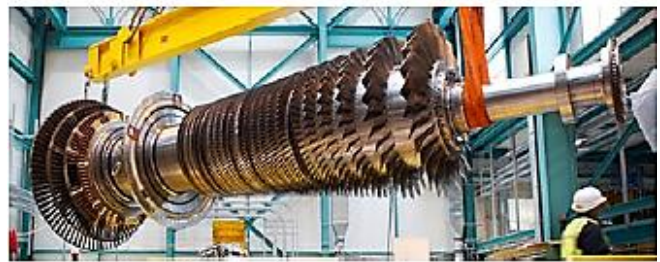
Turbine d'une centrale à gaz.
