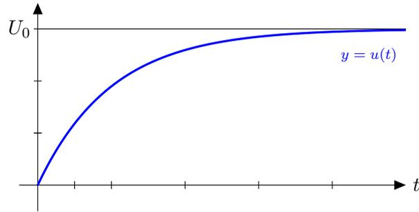
On constate que la tension  $u$  aux bornes du condensateur tend "rapidement" vers  $U_0$ . En régime permanent, le condensateur se comporte comme un interrupteur ouvert.
