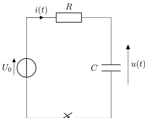
On ferme l'interrupteur à  $t = 0$ . Quel est le comportement de la tension aux bornes du condensateur ? La loi des mailles donne alors :
