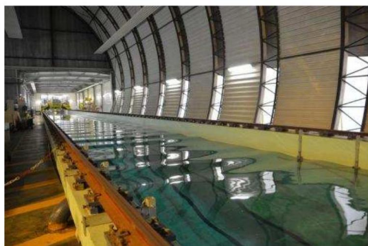
Figure 14 : Bassin de traction
