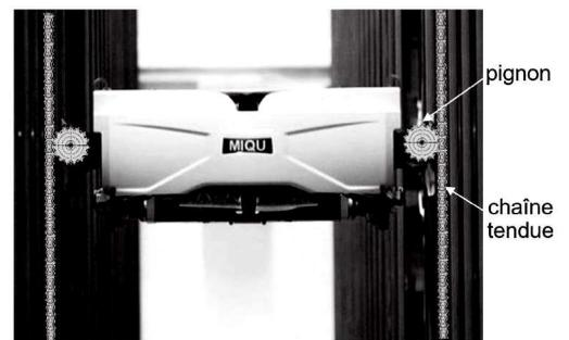
Figure 16 - Vue du robot en montée (sans charge ni bac), avec pignons et chaînes redessinés
