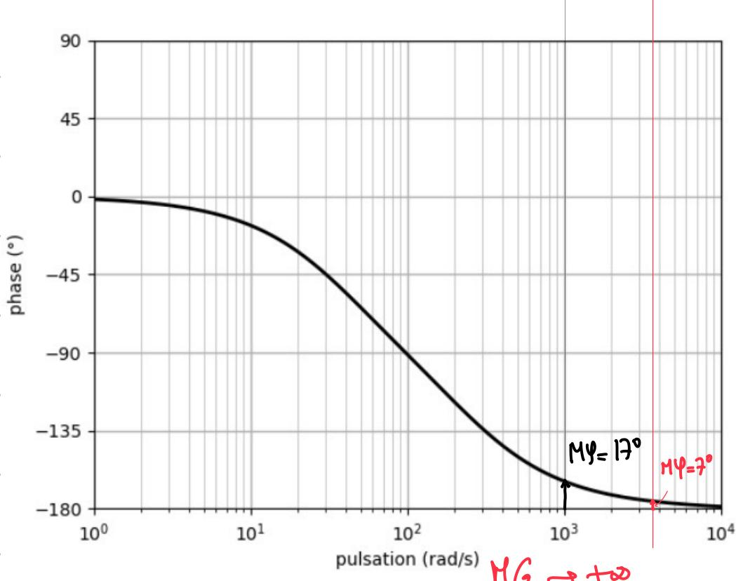
La marge de phase est beaucoup trop juste, il manque  $60 - 7 = 53^\circ$ , cela revient à dire qu'il faut remonter la phase de  $53^\circ$  pour  $\omega_{0dB} = 3500 \text{ rad/s}$
