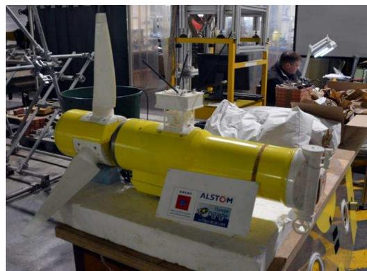
Figure 3 : Maquette de l'Hydrolienne testée par Alstom
