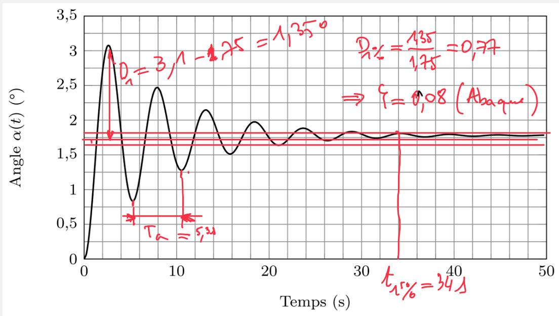
$t_{1,5\%} \times \omega_0 = 30$  (d'après l'Abaque temps de réponse réduit)
