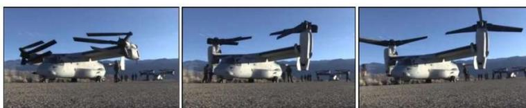
FIGURE 2 - Déploiement des moteurs, puis des pales
