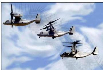
FIGURE 1 - Un V-22 Osprey, passant du mode « hélicoptère» au mode « avion»
