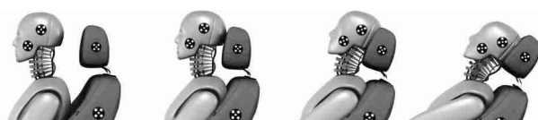
Figure 1 Réduction du phénomène du « coup du lapin » par l'usage d'un appui-tête (Référence : R.T. Shone)
