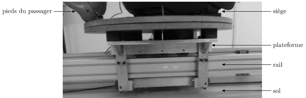
Figure 6 Solution retenue pour la réalisation de la liaison glissière entre l'ensemble mobile et le bâti
