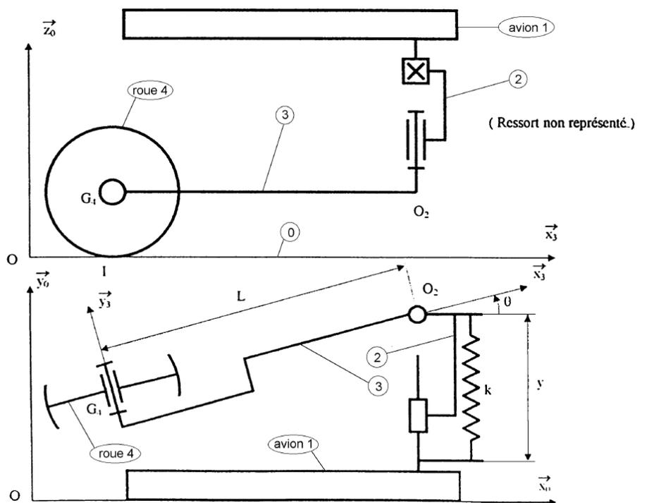
La liaison entre (2) et (3) est une liaison pivot avec une composante de frottement proportionnelle à la vitesse de rotation  $\dot{\theta}(t)$ . Le coefficient de proportionnalité est  $\mu$  avec  $\mu > 0$ .
